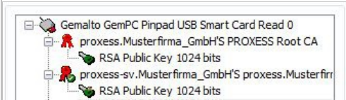
Abb.: Anzeige nach erfolgreicher Übertragung des PROXESS Supervisorzertifikates im Menü "Certificates"
